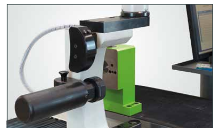
Support optique en option avec caméra à axe de rotation
