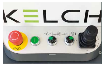
Panneau de commande avec joystick pour le déplacement des axes CNC
