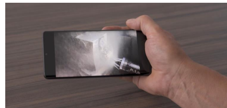
Diffusion en continu à l'intérieur et à l'extérieur du réseau via un encodeur IP et un NVR sur des appareils mobiles
